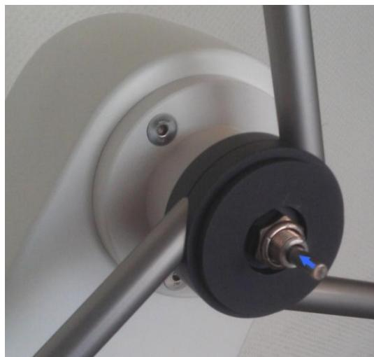
**OPERATION 4:** Mesurer la longueur « L » indiquée sur la photo, à l'aide d'un pied à coulisse ou d'un réglet. Pour pouvoir monter la molette de frein fournie avec la roue Triak, il faut  $L = 4\text{mm}$  (la tige ne doit donc pas dépasser de l'arbre)
