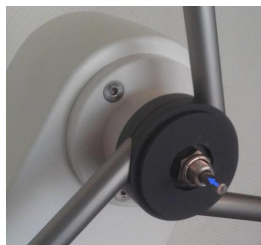
**OPERATION 7:** Monter la molette de frein en la vissant dans le trou taraudé M10 qui est en extrémité de l'arbre| Le frein de barre est actionné lorsque la molette est vissée à fond, dans le sens des aiguilles d'une montre.
