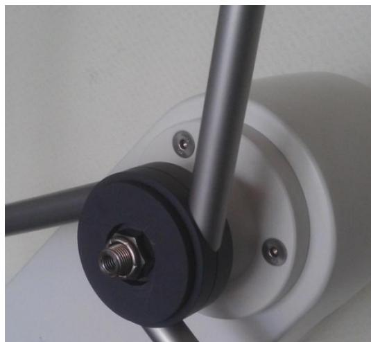
OPERATION 3: Insérer la tige (rallonge de frein) dans le trou taraudé de l'arbre. Pousser à fond pour qu'elle soit en contact avec le mécanisme de frein intérieur
