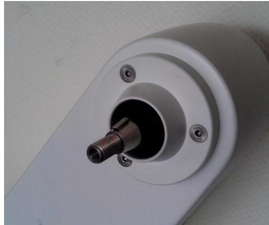
OPERATION 2: Monter la roue Triak sur le cone de l'arbre en vérifiant que la clavette reste bien en place. Serrer l'écrou central à fond
